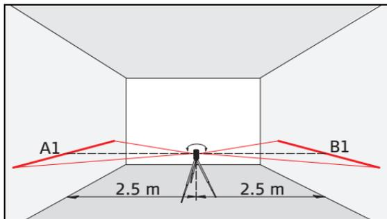
Estacionar el instrumento sobre un trípode y en el punto medio entre dos muros (A+B) que tengan una separación aproximada de. 5 m.
