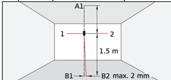
Estacionar el láser sobre un trípode o sobre un soporte para pared cerca del punto A1 a una distancia por lo menos de 1.5 m del punto B1. El láser horizontal está alineado en la dirección 1. Marcar los puntos láser A1 y B1 con un clavo.
