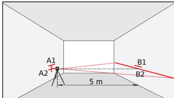
Colocar el instrumento a la misma altura lo más cerca posible del muro A y marcar nuevamente la línea horizontal láser o el punto láser sobre el muro A (-> A2). Girar nuevamente 180° el instrumento y marcar el láser sobre el muro B (-> B2). Medir las distancias de los puntos marcados A1-A2 y B1-B2. Calcular la diferencia entre ambas mediciones. Si la diferencia es menor de 2 mm, el Leica Lino estará dentro del intervalo de tolerancia.
