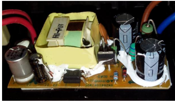
Figura 8.4. Fuente alimentación de 9 voltios.
