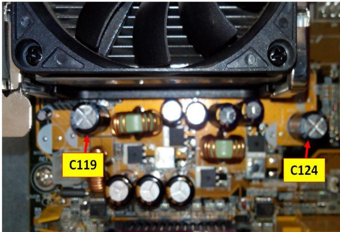
Figura 8.44. Localización condensadores C119 y C124.
