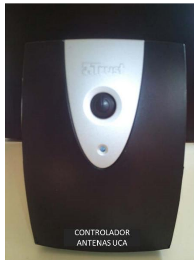
Figura 8.10.- Vista frontal del controlador seguidor de antenas.
