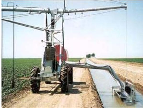
Fig 25. Obtención de agua por canal
