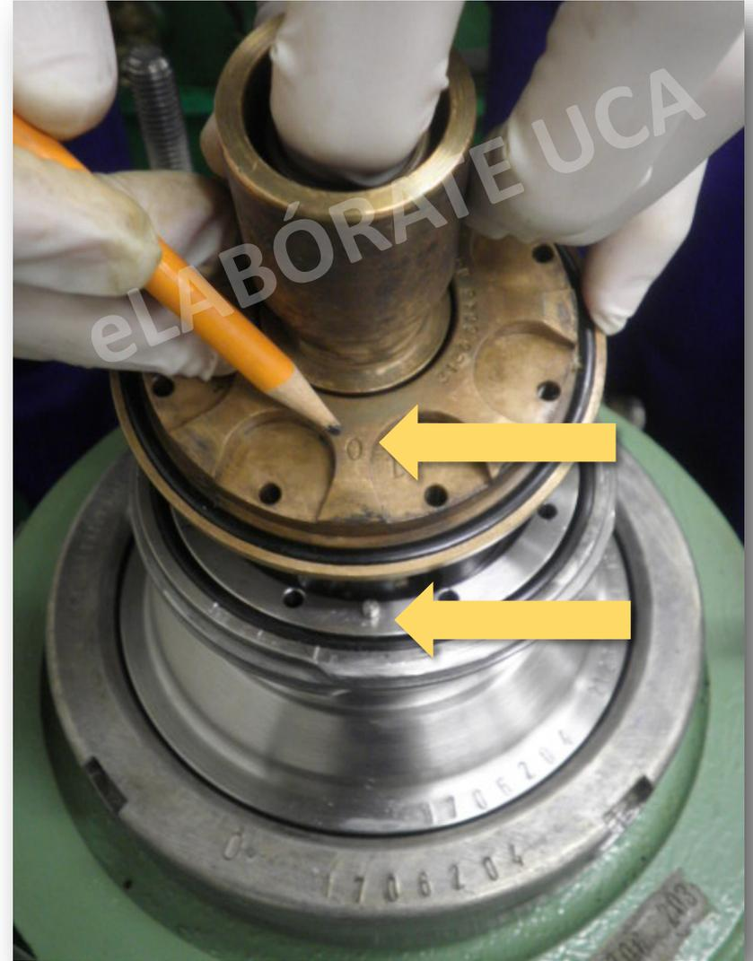
Colocar la bomba centrípeta, haciendo coincidir los dos rebajes con los dos tetones
