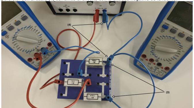
Queda solamente conectar el voltímetro en paralelo con la resistencia de  $100\Omega$  (cables 5 y 6).
