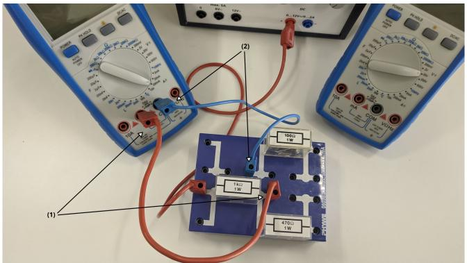
Con el cable (3) unimos los dos terminales libres de las resistencias para cerrar el paralelo. Con el cable (4) cerramos el circuito con la entrada negativa de la fuente.
