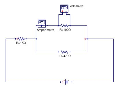
El medidor de corriente o eléctrica o amperímetro se encuentra en serie con la resistencia de  $100\Omega$  y el voltímetro o medidor de tensión en paralelo con la misma resistencia. En paralelo a la resistencia de  $100\Omega$  encontramos una resistencia de  $470\Omega$  y todo el conjunto en serie con una resistencia de  $1K\Omega$ . El circuito se alimenta con una fuente de voltaje continua.
