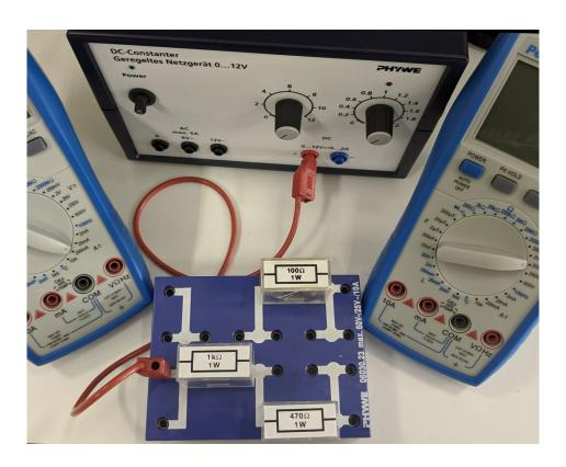
Conectamos el amperímetro en serie con la resistencia de  $100\Omega$ . El cable (1) desde la resistencia de  $1K\Omega$  a la terminal de entrada mA del dispositivo y el cable (2) desde la terminal COM hasta la resitencia de  $100\Omega$ .
