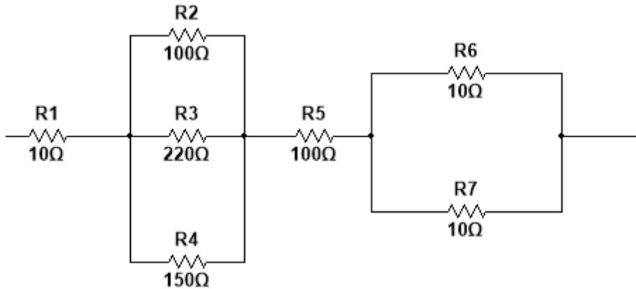
Fig 8: Montaje de resistencias configuración mixta
