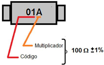
Fig 3: Ejemplo de codificación EIA-96
