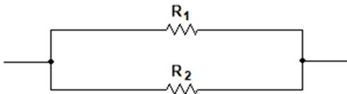
Para el caso particular de dos resistencias en paralelo, la resistencia total equivalente será:
