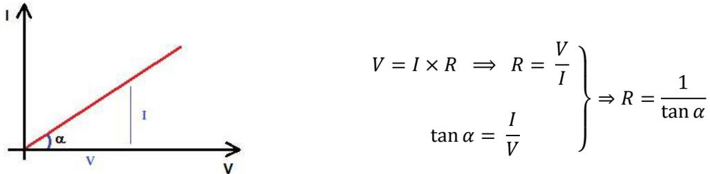
**Fig. 5:** Curva característica de las resistencias lineales.
