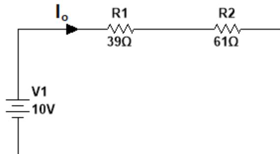
**Fig. 11** Aplicación de la ley de ohm
