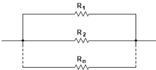
Calcular la resistencia total equivalente de un grupo de resistencias en paralelo, se obtiene como resultado de la suma de la inversa del valor óhmico de todas las resistencias.
