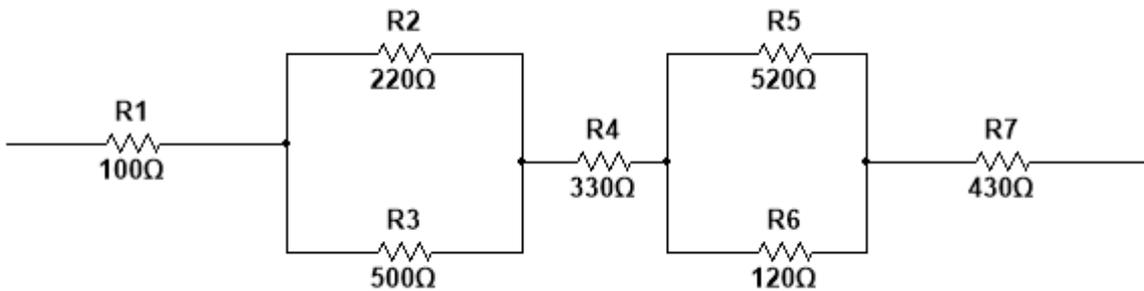
2. Calcula la resistencia total equivalente del circuito de la figura
