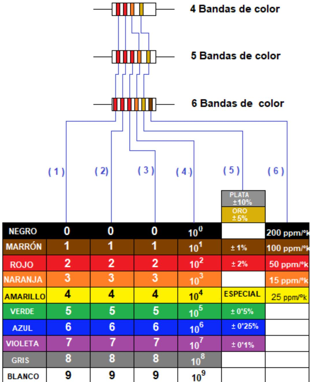
Fig 4: Valores para la codificación por bandas de color
