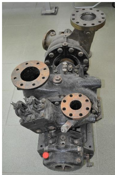
Turbobomba alimentación WEIR
