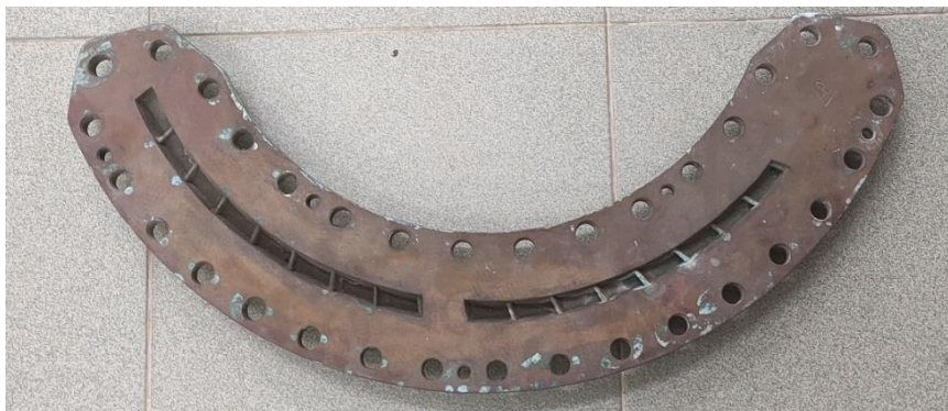
Sector de toberas (No corresponde a la turbina expuesta en el taller)
