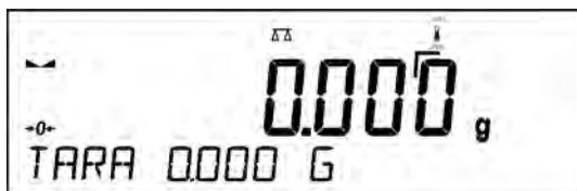
La aparición de un icono de termómetro pulsante, significa condiciones de temperatura inestables en peso, que puede causar mediciones de balanza inexactos. En este caso, espere hasta que las condiciones de temperatura se estabilizan o calibrar la balanza.
