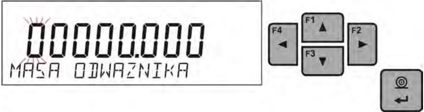
Después de introducción y comprobación del peso de la pesa patron, se mostrará el mensaje, que recomienda quitar de la carga del platillo **<QUITAR LA CARGA >** (le platillo tiene ser vacío) Después de vaciar el platillo, pulse
